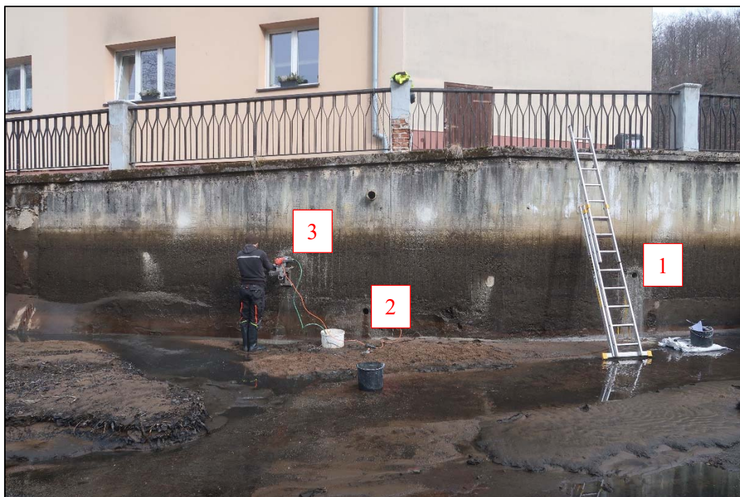
Foto 1: Poloha odběru jádrových vývrtů č. 1 až 3 z levobřežní zdi náhonu malé vodní elektrárny v Lokti; vrtání ukončeno na rozhraní betonové a kamenné části stěny; vývrt 1 proveden ve výšce cca 1,1m; vývrt 2 ve výšce 0,55m a vývrt 3 ve výšce 1,4m nad dnem náhonu
