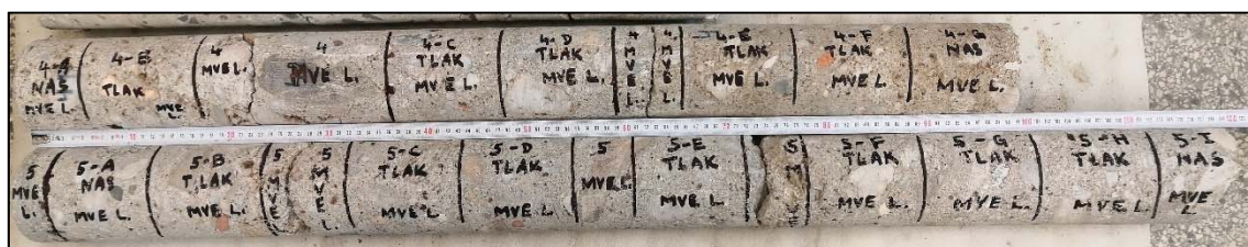
Foto 7: Bližší pohled na strukturu betonu pláště odebraných vývrtů 4 a 5 z levé části náhonu a z náběhu
