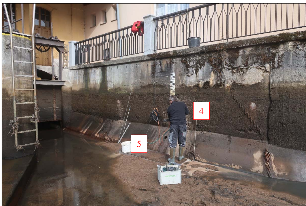
Foto 2: Poloha odběru jádrových vývrtů č. 4 a 5 z levobřežní zdi náhonu malé vodní elektrárny v Lokti; vývrt č. 5 odebrán z náběhu stěny náhonu; vývrt 4 proveden ve výšce 1,2m; vývrt 5 ve výšce cca 0,4m nad dnem náhonu
