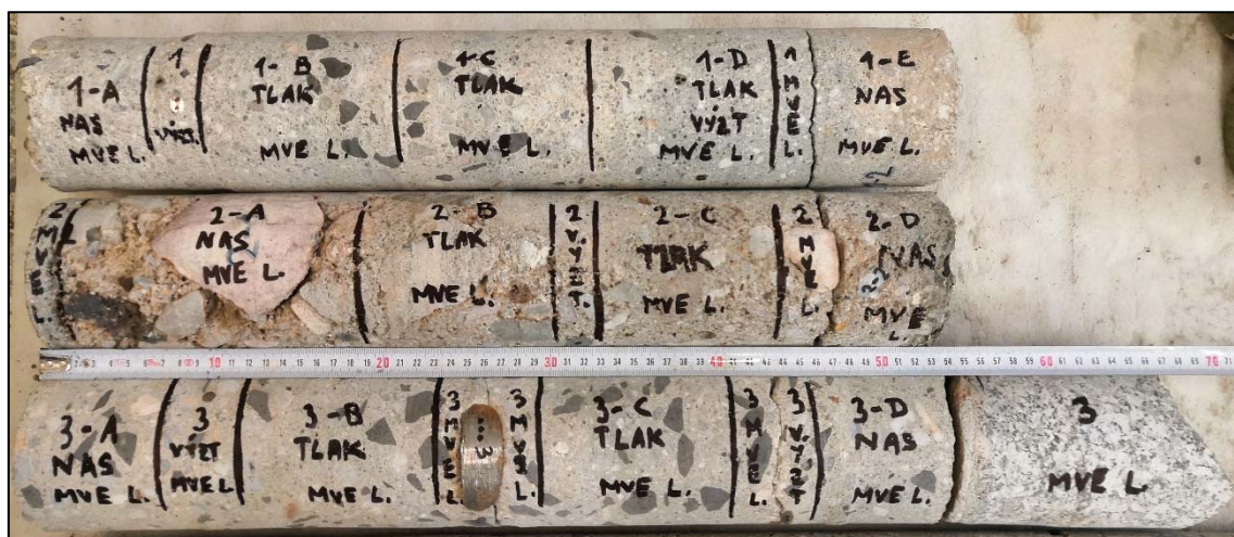
Foto 6: Bližší pohled na strukturu betonu pláště odebraných vývrtů 1 až 3 z pravé a střední části zdi náhonu; konec vývrtu č. 3 tvořen vyvřelou horninou (zřejmě původní stěnou náhonu)
