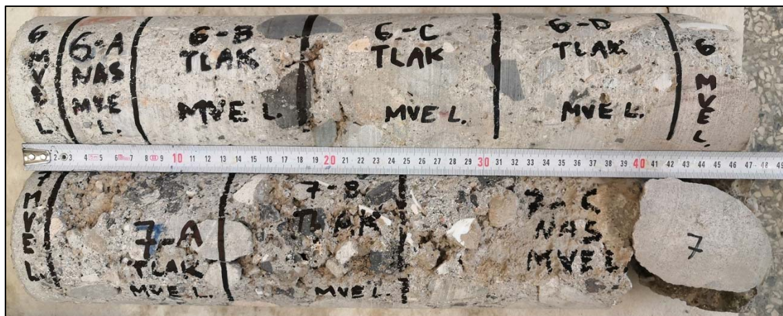
Foto 8: Bližší pohled na strukturu betonu pláště odebraných vývrtů 6 a 7 ze zdiva kašny č. 3
