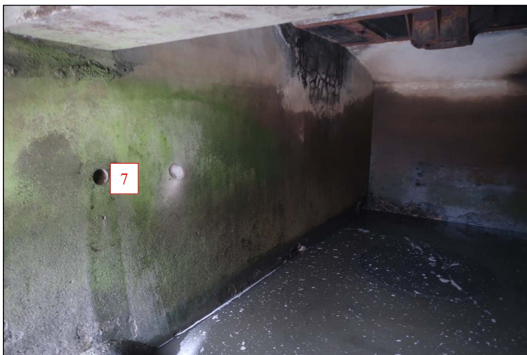
Foto 4: Poloha odběru vývrtnu č. 7 z pravé části stěny kašny č. 3; vývrt proveden na délku vrtací korunky; vývrt 7 proveden ve výšce 1,25m nad přelivnou hranou kašny č. 3
