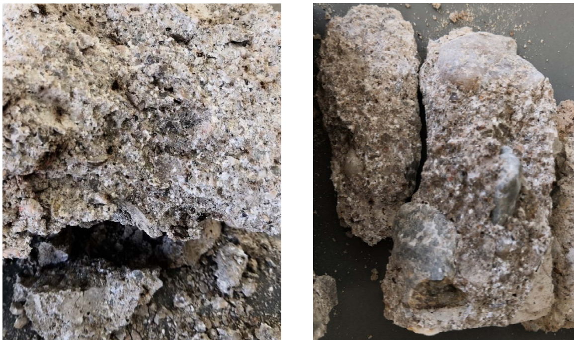
Obr. 2: Bílé vykrystalizované výluhy v pórech vzorku betonu
